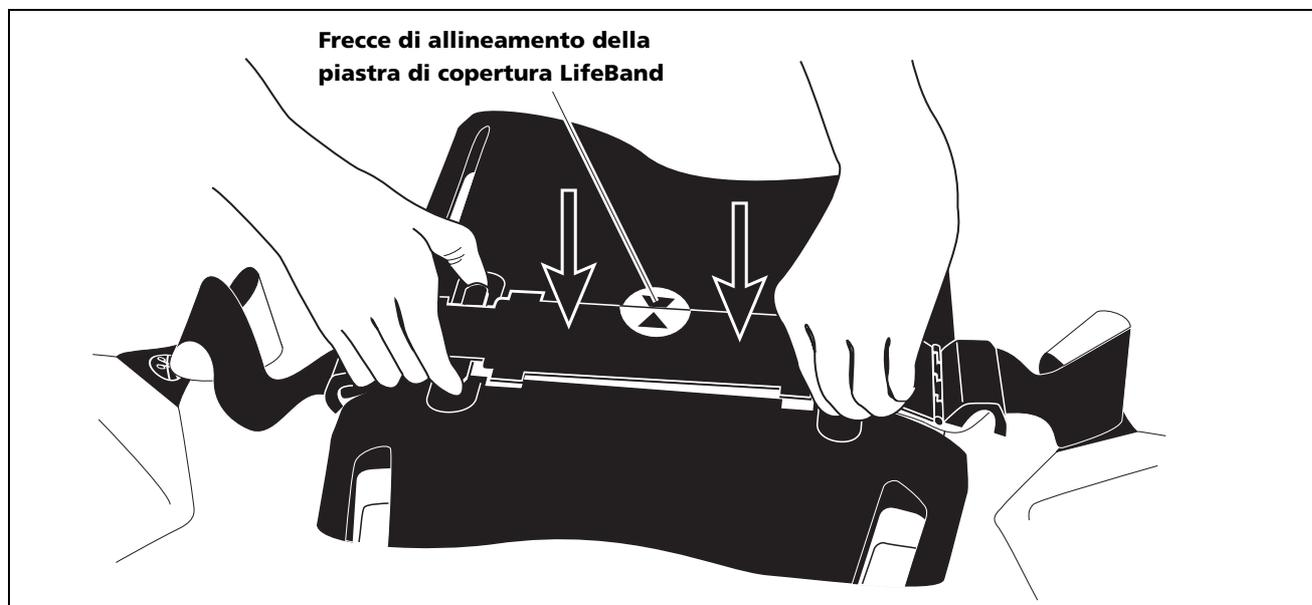
**Figura 2-3** La piastra di copertura LifeBand scatta in sede
